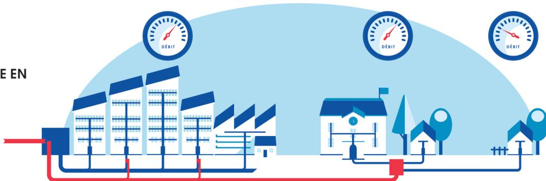
La montée en débit consiste à remplacer partiellement les réseaux historiques (cuivre ou câble coaxial) par des réseaux de fibre optique, afin d'améliorer les débits offerts et d'apporter le très haut débit<sup>1</sup> à une partie des usagers. Plus rapides et moins coûteuses à déployer, de telles opérations peuvent constituer des solutions transitoires avant le déploiement à terme de la fibre jusqu'à l'abonné.
